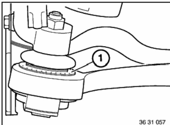
Si la pièce en caoutchouc (1) présente un gonflement, il faut remplacer la rotule de guidage, voir 31 12 025.
