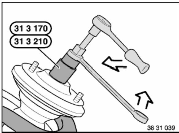
Déposer l'écrou avec l'outil spécial 31 3 170/210 - remplacer éventuellement la douille - et dégager le combiné ressort/amortisseur.
