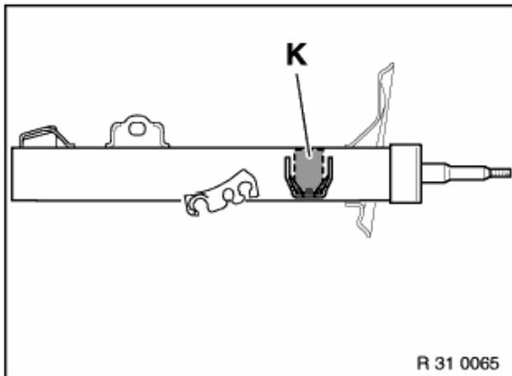
En cas de remplacement d'un combiné ressort/amortisseur, il faut toujours monter un combiné ressort/amortisseur portant la même étiquette d'identification (K).
