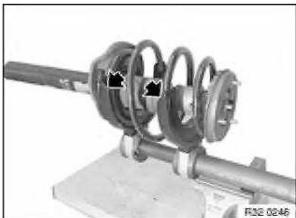
Positionner le ressort sur l'outil spécial en plaçant les spires inférieure et supérieure entre les prises de ressort.
