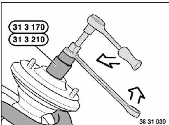
Remplacer l'écrou autobloquant et serrer avec l'outil spécial 31 3 170/210 - remplacer éventuellement la douille.
