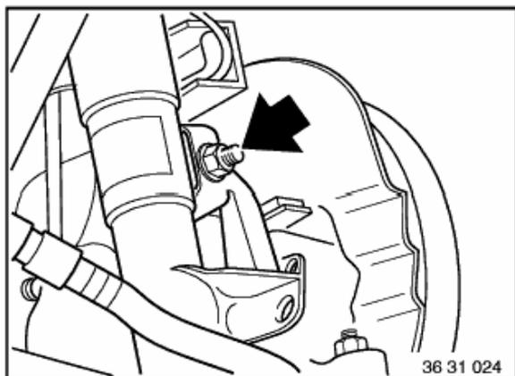
Déposer la vis calibrée.
